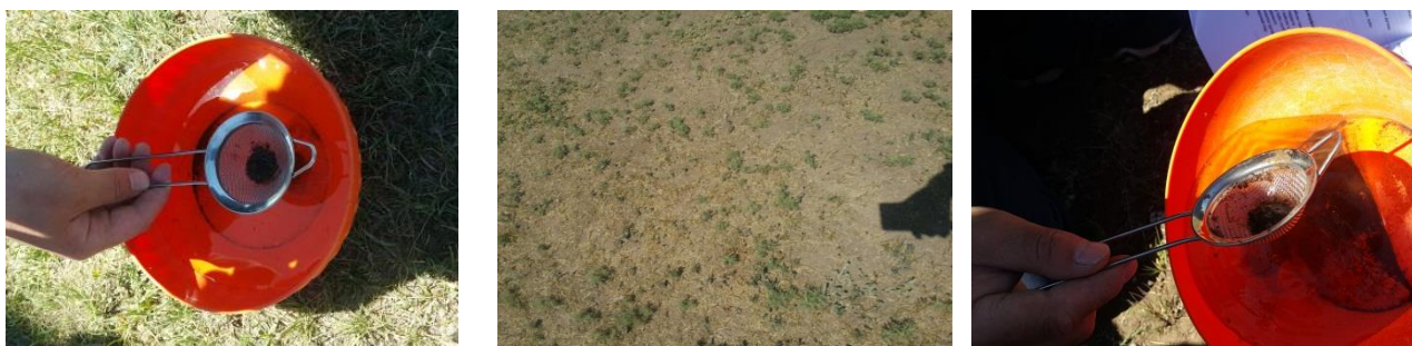
Зураг 4. Уурхайн талбайн хөрсний тогтвортой байдлын ангилал 3 баллын дунд зэрэг тогтвортой хөрс
