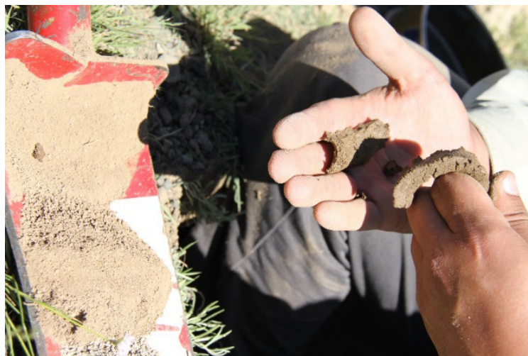
Зураг 3. Хөрсний механик бүрэлдэхүүнийг талбайд тодорхойлж байна.
