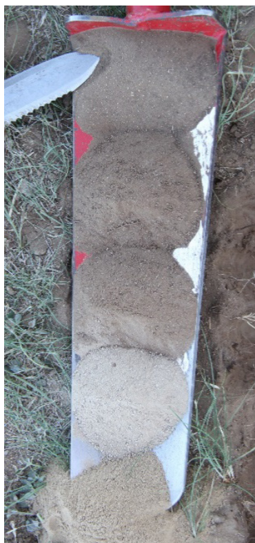
Зураг 2. Төв аймгийн Өндөрширээт сумын нутагт Бэрхийн хөндийд хөрсний зүсэлт хийж үе давхарга зузааныг тодорхойлсон байдал
