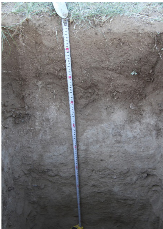
Зураг 2. Төв аймгийн Өндөрширээт сумын нутагт Бэрхийн хөндийд хөрсний зүсэлт хийж үе давхарга зузааныг тодорхойлсон байдал
